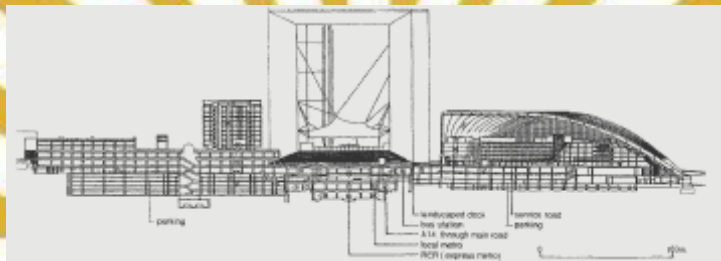
تصویر ۵-۱- مقطع و برش عرضی از لادفانس و مجموعه آن (Lang, 2005: 220)
