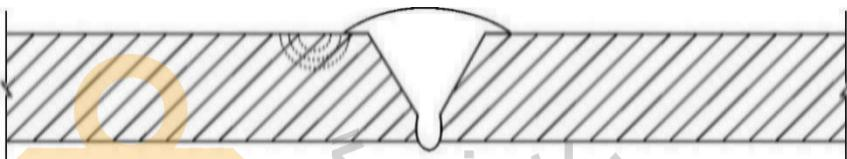
شکل ۱۷-۶-۵ سوختگی ناشی از قوس الکتریکی
