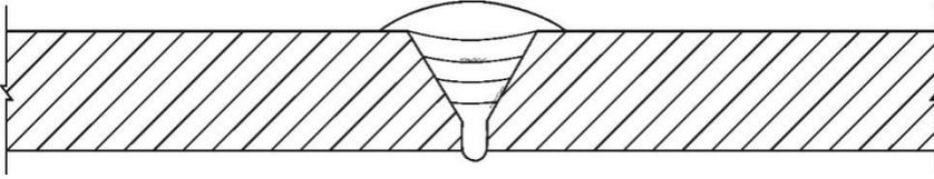
شکل ۱۷-۶-۷ ذوب ناقص در اثر جوش سرد
