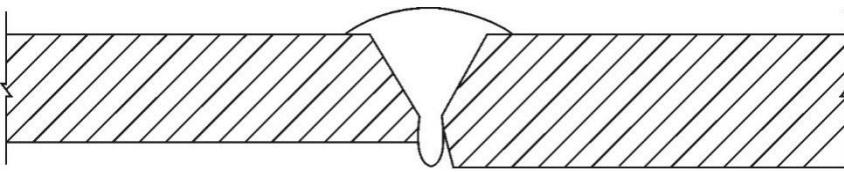
شکل ۶-۱۷-۱۰ عدم نفوذ در ریشه جوش از یک طرف
