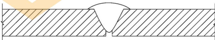
شکل ۶-۱۷-۹ عدم نفوذ در ریشه جوش
