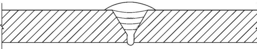
شکل ۶-۱۷-۷ ذوب ناقص در اثر جوش سرد
