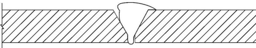
شکل ۱۷-۶-۶ ذوب ناقص در ریشه یا تاج جوش
