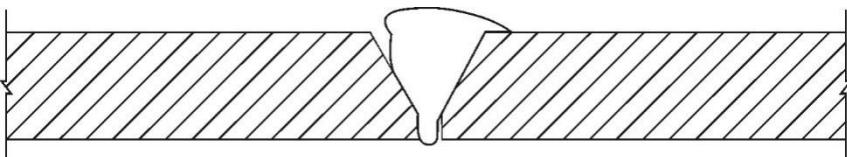
شکل ۱۷-۶-۶ ذوب ناقص در ریشه یا تاج جوش
